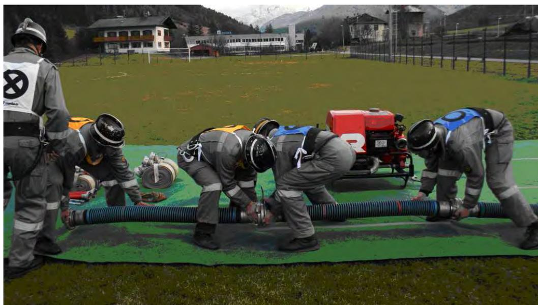
Abb. 7b Kuppeln der Saugschläuche durch Wassertrupp und Schlauchtrupp
