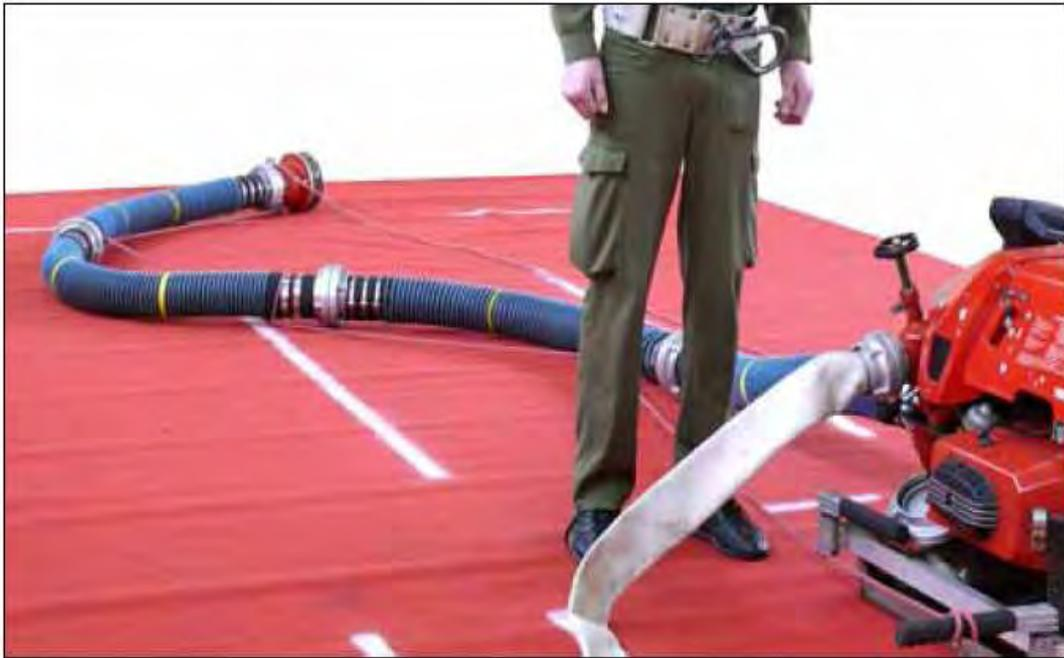
Abb. 16: Befestigen Saugschlauchleine an der TS
