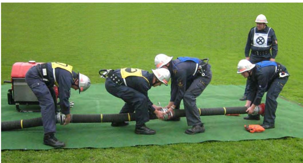
Abb. 7a: Kuppeln der Saugschläuche durch Wassertrupp und Schlauchtrupp
