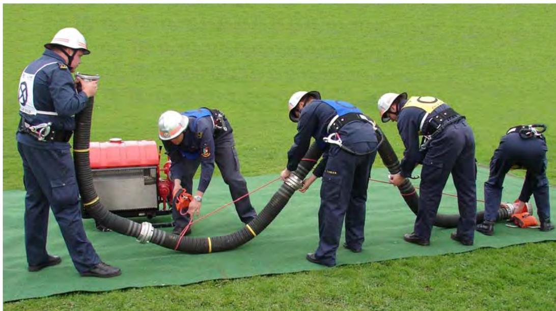
Abb.12: Tragen der Saugschlauchleitung Richtung Wasserentnahmestelle
