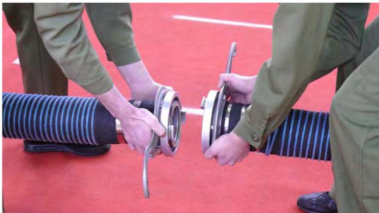
Abb.8a: Ansetzen der Kupplungsschlüssel und das Kuppeln der Saugschläuche
