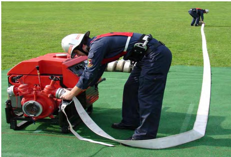
Abb.17: Ankuppeln und Auslegen des ersten B- Schlauches
