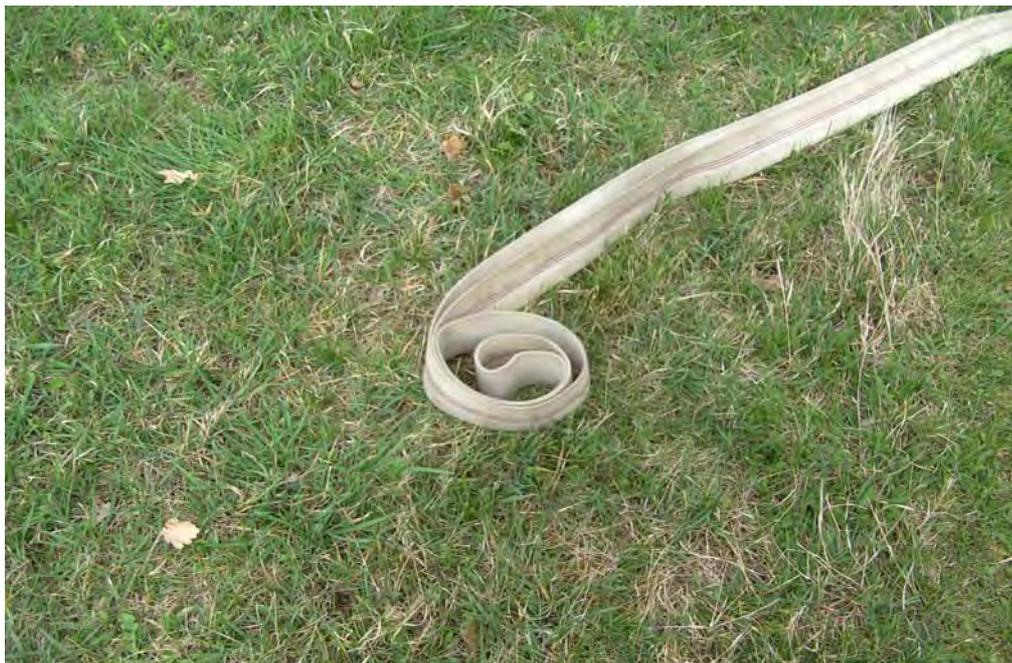
Abb. 21b Schlecht ausgelegter Druckschlauch „Schnecke“
