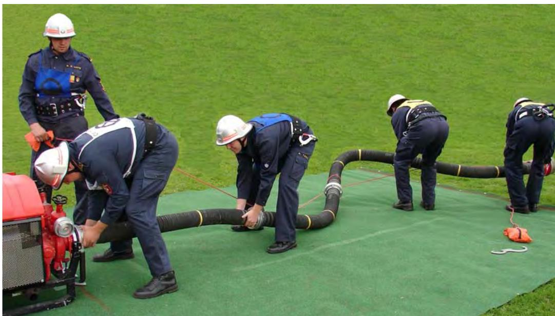
Abb. 14: Ankuppeln der Saugschlauchleitung an die Tragkraftspritze
