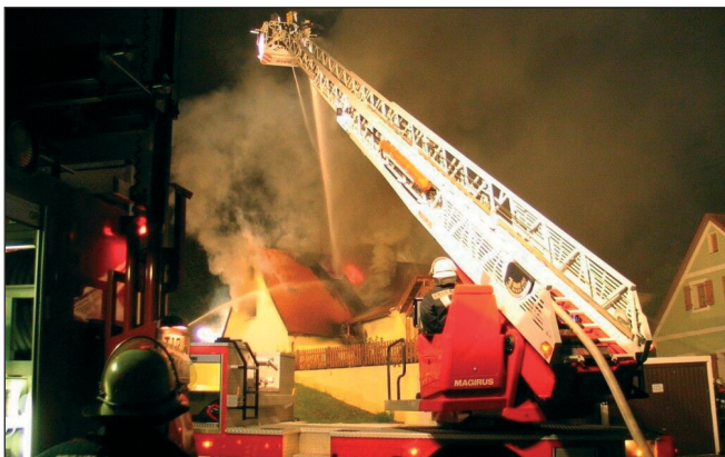
Bild 9: Wasserabgabe von der Drehleiter
